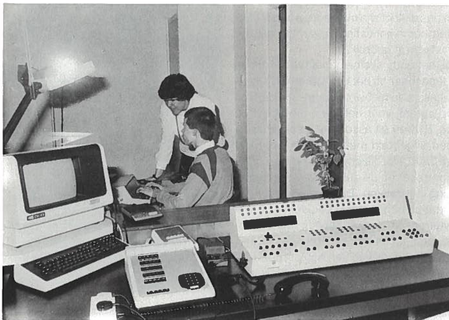
Introductieruimte voor de blindenbedieninrichting met op de voorgrond het aanstuurbedieningspaneel en beeldscherm als observatie-monitor.
